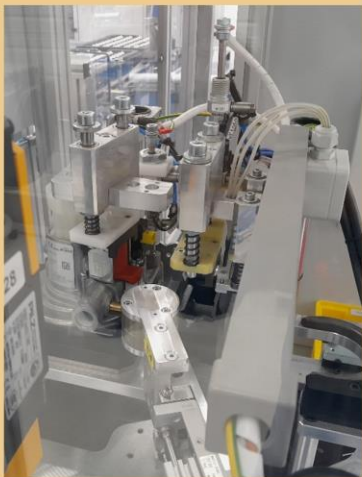
Postaja za visokonapetostno testiranje izdelka
