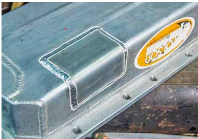
Slika 1: Primer popravila strojnega dela, varjeno po TIG postopku
