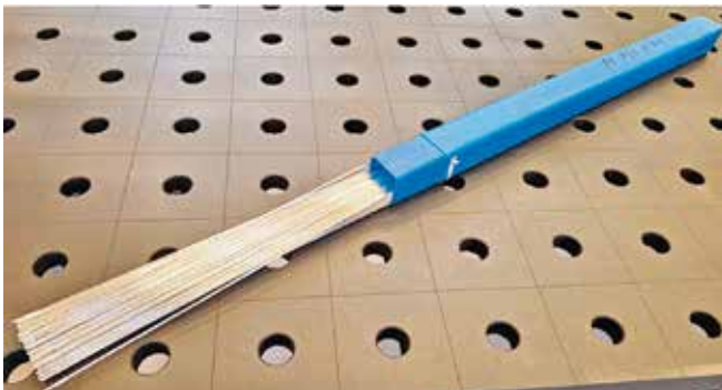
Slika 3: Al dodajni material za TIG varjenje. AL Mg5 premera 2.4 mm.
