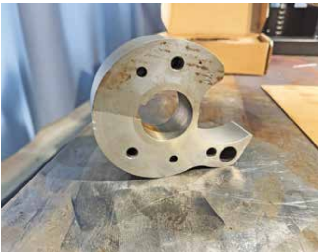
Slika 5: Rotor – primerjava pred čiščenjem in po čiščenju (Lasten vir)
