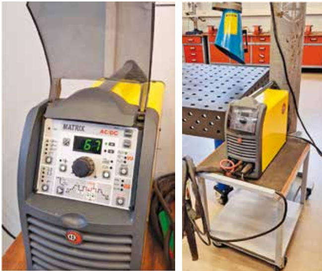
Slika 2: TIG varilni aparat s funkcijo varjenja z izmeničnim tokom AC
