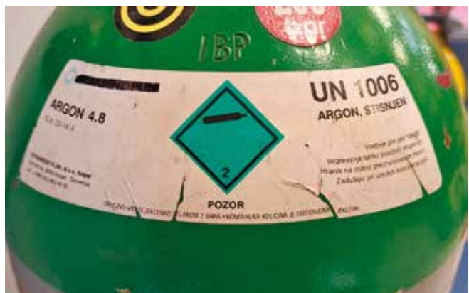
Slika 6: Argon je označen s temno zeleno barvo. Za varjenje po TIG in MIG postopku se uporablja Ar 4.6 ali 4.8
