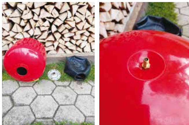
Slika 3: Zračni ventil in sestava ekspanzijske posode
