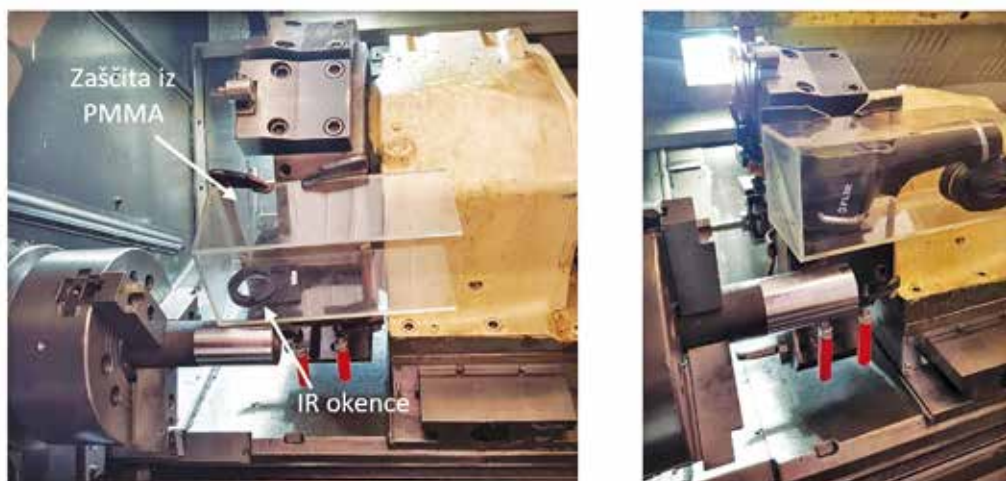
Slika 3: Namestitev IR-kamere in zaščite iz PMMA (pleksi).
