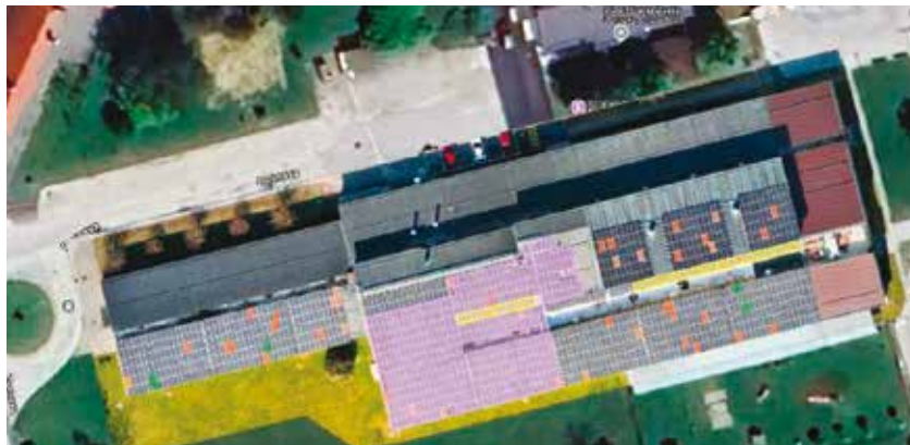
Slika 6: Označene napake na MFE OŠ Franja Žgeča Dornava [9]
